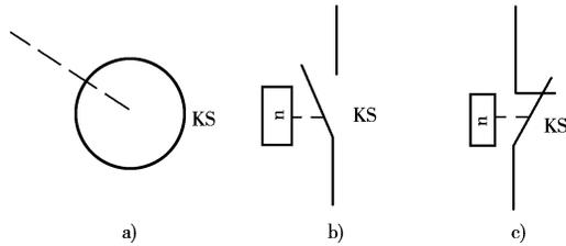
图 1-24 速度继电器的图形符号、文字符号
