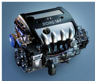
这是一款现代汽车的直列4缸轿车用汽油机，采用双顶置式凸轮轴配气机构（DOHC，Double Overhead Camshaft），共16气阀，每缸4气阀，排量为1.6升，功率约82kW。
