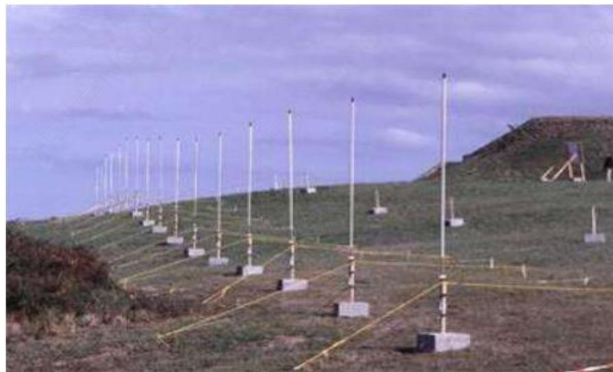
高频地波雷达 (High Frequency Radar, HFR) 利用短波 (3-30MHz) 在导电海洋表面绕射传播衰减的特点, 采用垂直极化天线辐射电波, 能超视距探测海平面视线以下出现的舰船、飞机、冰山和导弹等运动目标, 其作用距离可达300 km以上。
