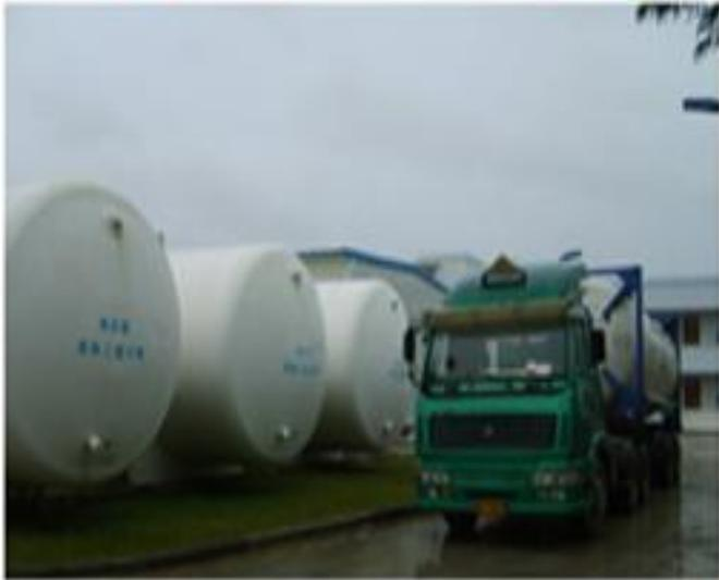
这种集装箱是专为装运液体货物，如酒类、汽油、化学品而设计的。它由罐体和框架两部分组成，罐体用于装载液体，框架用来支承和固定罐体。罐体的外壁采用保温材料以使罐体隔热，内壁一般要研磨抛光以避免液体残留在壁面。
