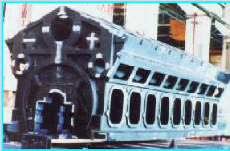
大型船用柴油机汽缸体
