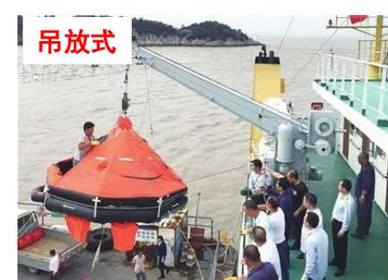
一般船舶多数使用的是**玻璃钢结构的全封闭救生艇**和**气胀式救生筏**。
