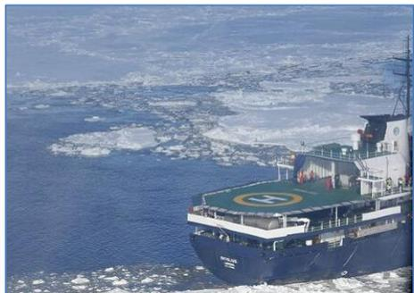
(3) 在甲板上设置一吊运区，具体要求如下：①在半径15m范围内无任何障碍物；②吊运区中央须标注白色“H”字样；③夜间应尽量将吊运区照亮，向上层建筑用灯光照明或在顶部显示红灯；④夜间将探照灯开亮，垂直向上照射，以便向从远方飞来的直升机显示本船的位置，但在飞机临近时应将灯关闭。⑤吊运区应远离船上的易燃物、爆炸物，以防止静电引起火灾和爆炸。⑥由于某种原因不能在准备好的吊运区作业时，可放下救生艇间接地进行作业。
