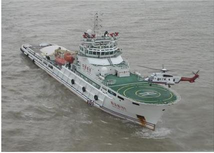
(5) 当直升机按常规由船舶的尾部方向接近遇险船舶时，船长应亲自指挥船舶操纵，使船舶以船首 $20^{\circ}$  - $30^{\circ}$  偏顶风，并以10-15kn船速前进。若吊运区不在船尾，则应使船首右舷侧以 $20^{\circ}$  - $30^{\circ}$  顶风航进。若船舶和直升机之间已建立起通信联络，则应按直升机驾驶员指示操作。
