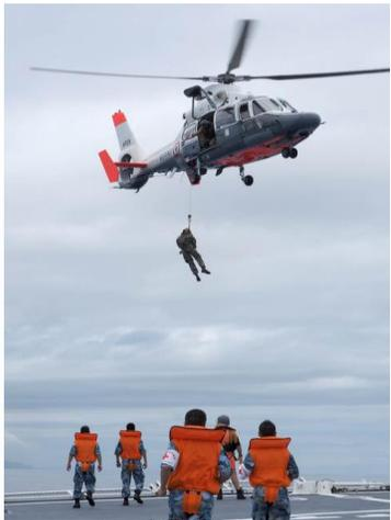
(6) 直升机放下的吊升设备在未接触海水之前，船上人员切勿用手接触或抓握其的金属部位，以防止静电放电所造成的无谓伤害。
