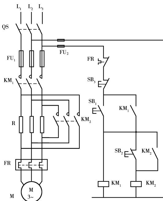
图 2-8 手动控制降压起动控制
