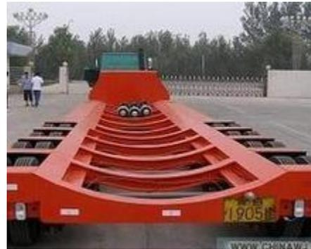
图 2-7 骨架式集装箱半挂车
