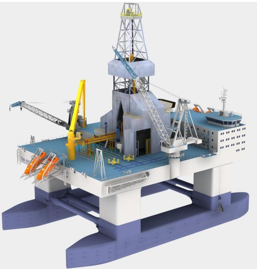
半潜式钻井平台（SEMI）由上部为**工作甲板**，下部为**两个下船体**，用**支撑立柱**连接。工作时下船体潜入水中，甲板处于水上安全高度，水线面积小，波浪影响小，稳定性好、自持力强、工作水深大，新发展的动力定位技术用于半潜式平台后，工作水深可达**3000**米。
