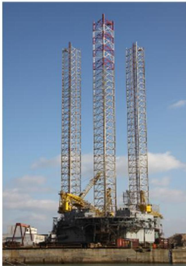
由升降桩腿和桩腿支撑的平台构成,平台可沿桩腿上升高于海平面,移动时平台可降至水平由拖轮托拽,移动。
