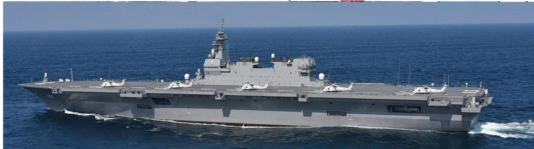
日本的多用途驱逐舰（直升机航母），2个螺旋桨，4台LM2500燃气轮机
