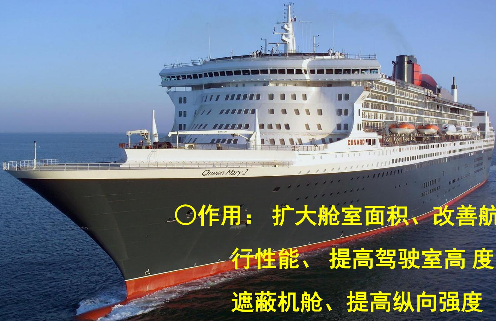
○作用：扩大舱室面积、改善航行性能、提高驾驶室高度、遮蔽机舱、提高纵向强度
