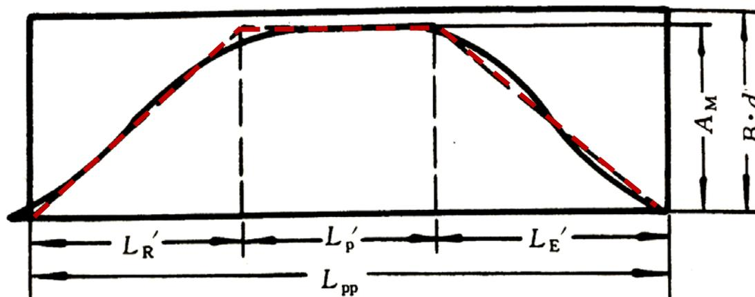
(2) 由这个梯形，可以作出面积相等的光顺曲线，曲线的形状应符合横剖面面积曲线的基本要求，如首尾端的凹凸性。经过调整、计算和修改，最后得出符合设计要求的横剖面面积曲线。
