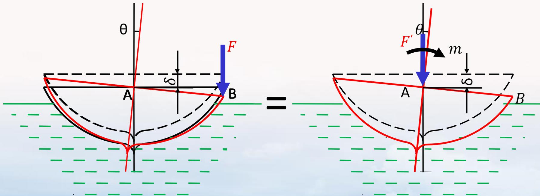
**力的平移定理：**作用在刚体上 $B$ 点的力 $F$ 可向刚体内任一点 $A$  **平移**，但必须附加一个力偶 $m$ ，这个力偶的力偶矩等于原来的力 $F$ 对 $A$ 点的矩： $F' = F$ ， $m = m_A(F)$
